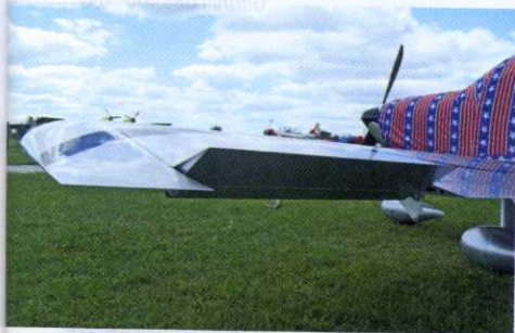
Аэродинамическая компенсация и весовая балансировка элеронов, мощная механизация, роговая компенсация рулей высоты
